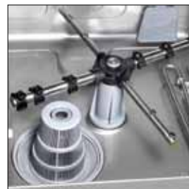
Nuevo filtrado aún más exclusivo: La altura del filtro ha sido elevada un 30% para no dejar pasar nada, ni al desagüe ni a la bomba. El desagüe va hasta el exterior de la máquina, facilitando la limpieza.
