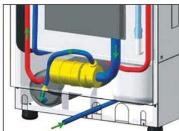
El sistema **WAGP** ofrece excelentes resultados de aclarado, ya que dispone de una reserva de agua incorporada que, a través de una bomba, asegura una presión y un caudal constantes independientemente de la presión de alimentación. Previene los reflujos en caso de baja presión en la red. Esto garantiza el cumplimiento de las normativas higiénicas europeas (HACCP).
