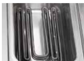
Elementos calefactores tubulares de acero inox, sumergibles en aceite, rotables hasta 90° para facilitar la limpieza.
