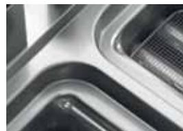
Depósito de acero inox con bordes redondeados en pendiente, conectado a un recipiente de acero inox para recuperar el aceite.
